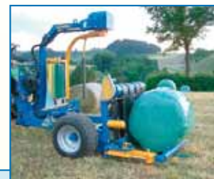
Décharge en douceur par table d'enrobage basculante
